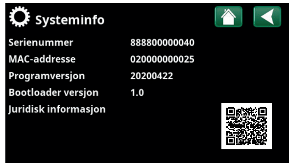
Meny «Avansert/Systeminformasjon». For å åpne denne menyen klikker du på knappen «i» nederst til høyre i menyen «Avansert».
