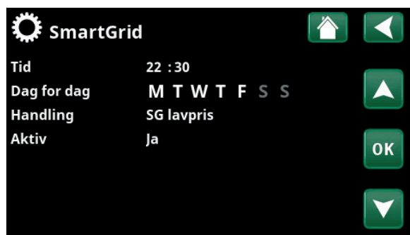
SmartGrid-funksjonen «SG Lavpris» planlegges hverdager klokken 22.30–06.00. Gå til menyen ved å velge «SmartGrid ukeskjema» i menyen «Avansert/Innstillinger».
